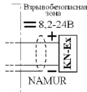
- б - с изолирующим усилителем стандарта NAMUR
